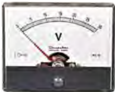
▲ El voltaje entre dos puntos en un circuito puede ser medido con un voltímetro, y su valor depende de la ubicación de los puntos escogidos en el circuito.
